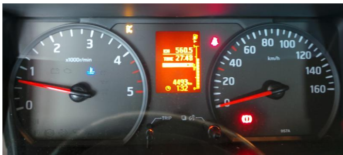
Afb. 5-10 Display in de bestuurderscabine van de vrachtwagen met weergave voor power take-off (Afhankelijk van het type voertuig)
