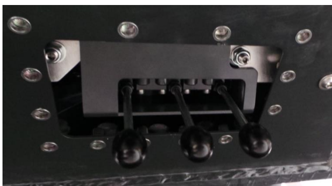
Afb. 5-18 Noodbesturingseenheid op de bovenwagen (Weergave zonder afdekkap met gemonteerde noodbesturingshendel)
