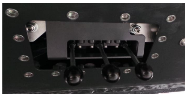
Afb. 10-12 Noodbesturingseenheid op de boven-wagen (Weergave zonder af dekkap met gemonteerde noodbesturingshendels)
