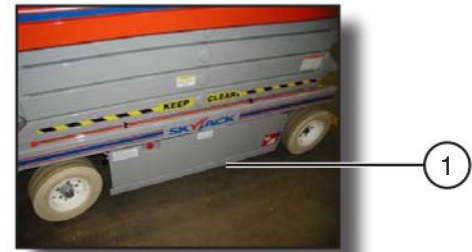
Figuur 2-7. Bescherming tegen kuilen
